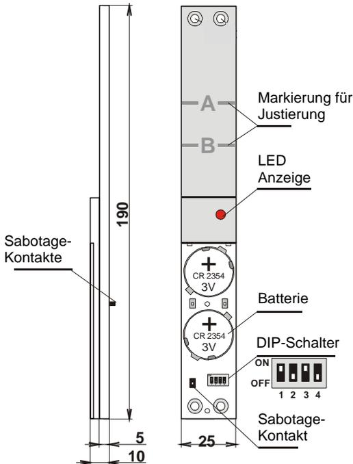
**LED-Anzeige** – 15 Minuten nach dem Schließen des Batteriefachdeckels zeigt die LED ein Auslösen des Melders an (ein blinkendes Licht signalisiert das Öffnen eines Fensters, ein dauerhaft leuchtendes Licht signalisiert das Auslösen der beiden Sabotagekontakte).
