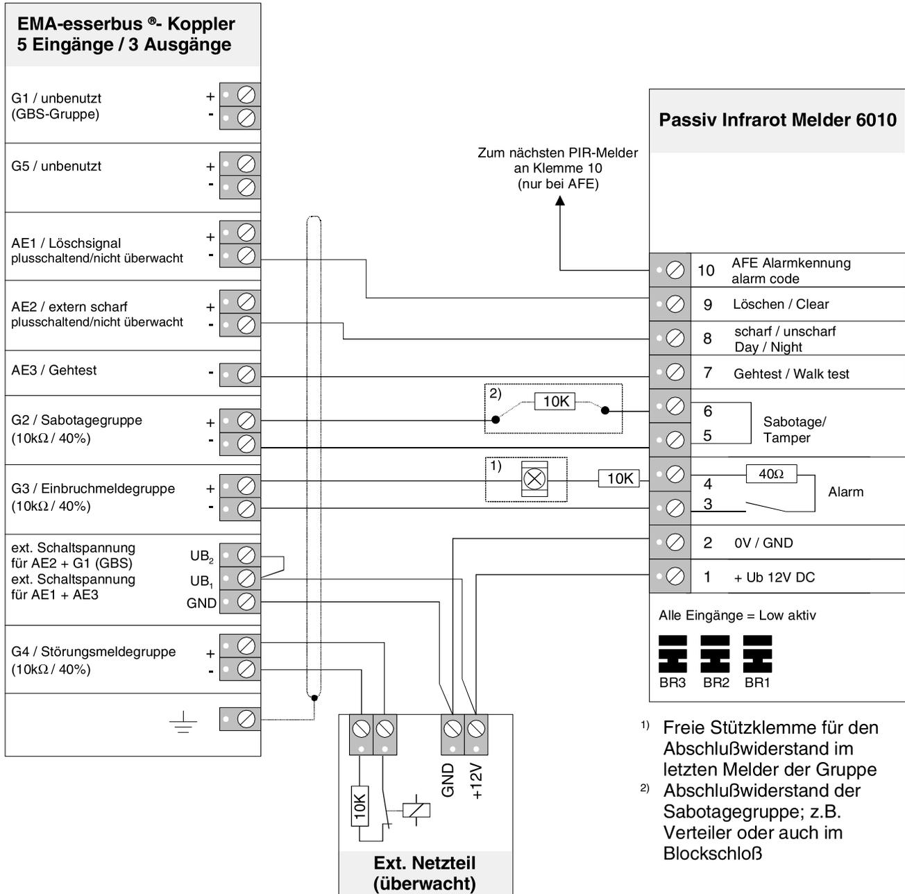
Abb. 3: Anschaltbeispiel zum Passiv-Infrarotmelder 166010 (Standard-B)
