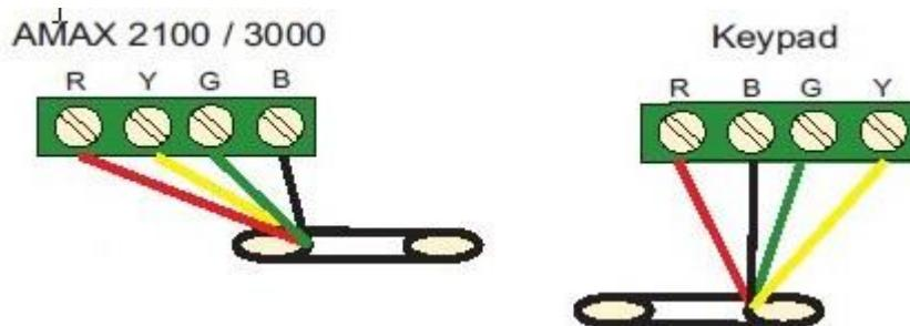
Bitte darauf achten, dass wirklich die richtigen Klemmen angeschlossen werden (im Idealfall JY-(ST)-Y oder Netzwerkkabel verwenden). Die Reihenfolge am Bedienteil ist anders, als an der Hauptplatine.
