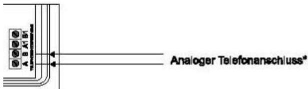
Weitere externe Geräte wie zum Beispiel Telefon und/oder Anrufbeantworter werden an A1/B1 angeschlossen. Versucht das GSM-Sprachwählgerät einen Wählvorgang zu starten, werden externe Geräte von der Telefonleitung automatisch abgetrennt.
